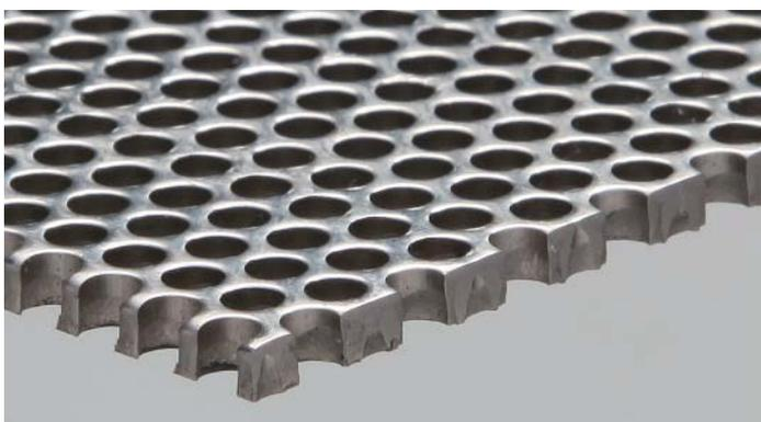
板厚より小孔径をパンチングプレス加工により実現した
